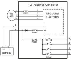
Fuse1: 100 mA Fuse2: 750 mA Fuse3: 6 A
